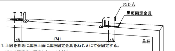
1. 上図を参考に黒板上面に黒板固定金具をねじ A にて仮固定する。
