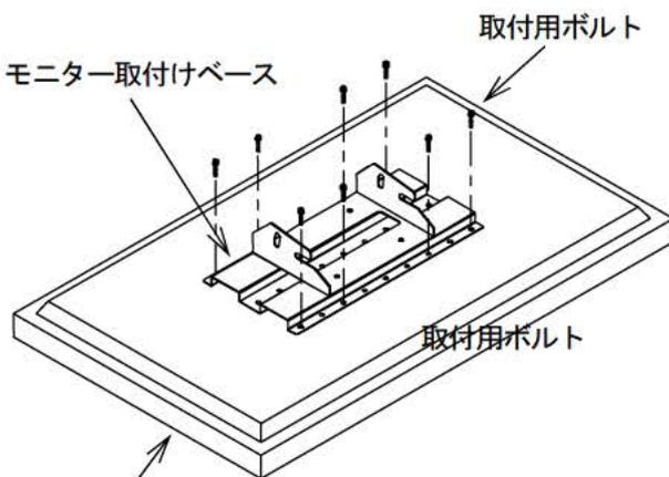
4. 取付けベースの左右いずれか一方をち上げ、次にスペーサーをモニター背面の該当するネジ穴上に載置後、取付け用ボルトを通し、モニターパネルメネジ部の一番奥まで手回しによりねじ込む。(スペーサー、取付け用ボルトは、モニター取付け用ボルトセットに梱包)
