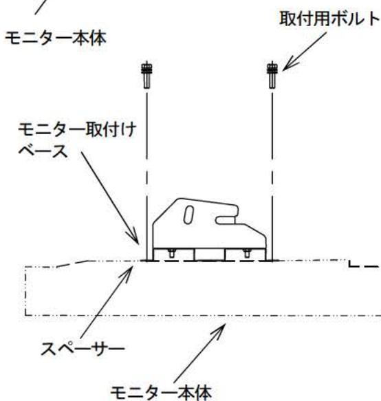
5. 次に、もう片方の取付けベース部位にも同様にスペーサーをはさみ、取付け用ボルトをモニターパネルメネジ部の一番奥まで手回しによりねじ込む。
