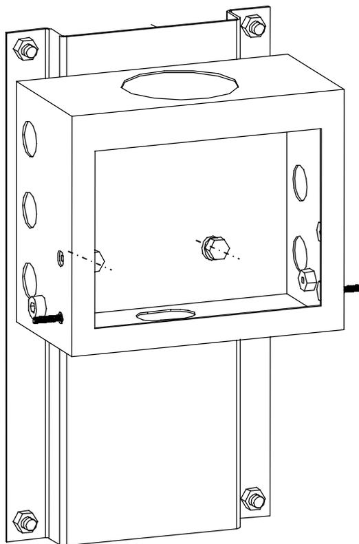
1. 取付ユニットを壁面にあらかじめ取付けられたネジと締結する。
