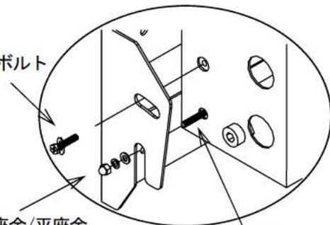
※ 設置後の傾斜調整は、所定の角度に調整した後、ゆるめた袋ナット、十字アプセットボルトを確実に、締付けてください。
