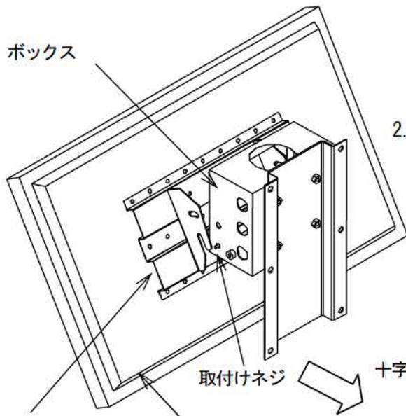
2. モニターを保持した状態で、左右の取付けベース挟み込み、袋ナット/バネ座金/平座金と十字アプセットボルトをねじ込み、モニターを好みの角度に調整後、再度六角スパナで上記ナット、ボルトを確実に、締付けて下さい。
