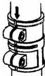
● 矢印の隙間が1mm以下にならない様に締め付けて下さい。
