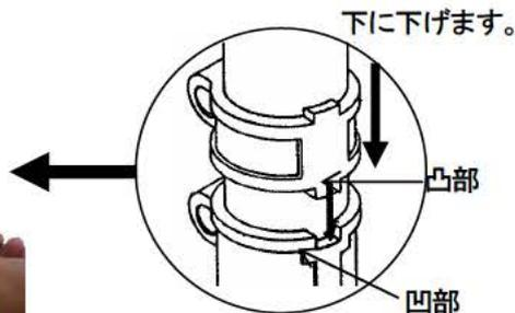
※ キーロックの凸部がブラケットの凹部に入り込む様に下げて下さい。
